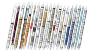
รูปที่ 11 แสดงตัวอย่างหลอดตรวจวัดสาร (Detector Tubes)
